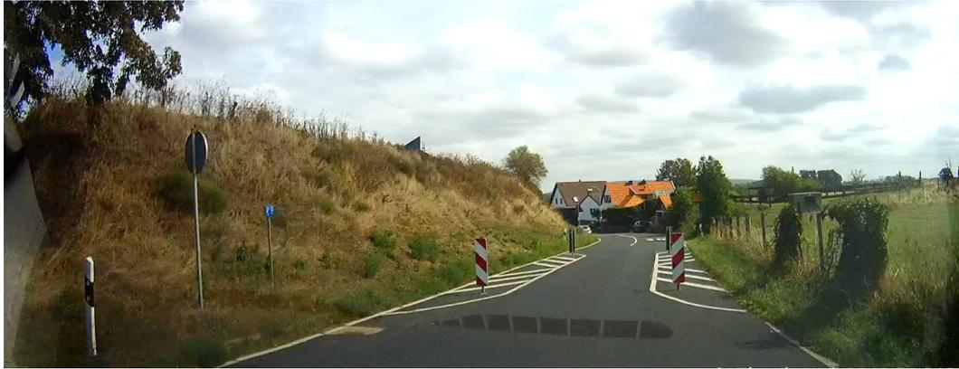
Abbildung 3: Fahrbahneinschnürung als geschwindigkeitsdämpfendes Element
